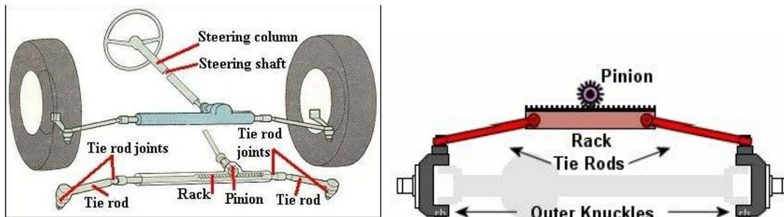
**VIDEO ON CONSTRUCTION AND OPERATION OF RACK & PINION TEERING SYSTEM**
