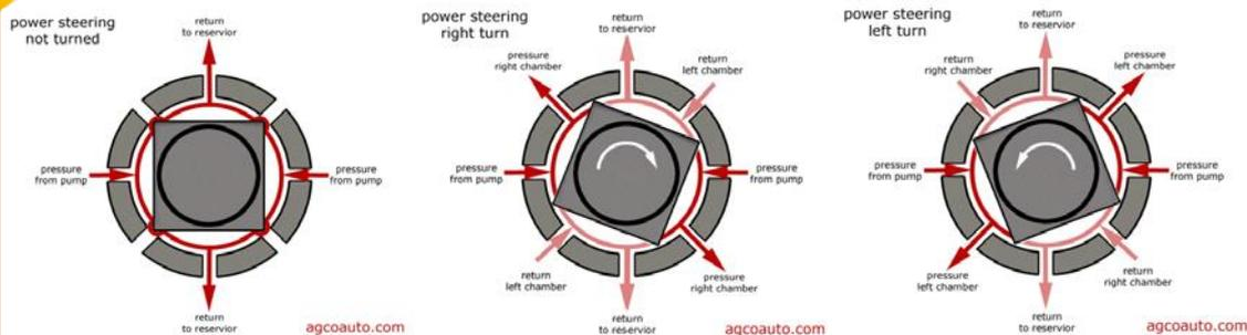
**VIDEO ON OPERATION OF HYDRAULIC POWER STEERING SYSTEM**
